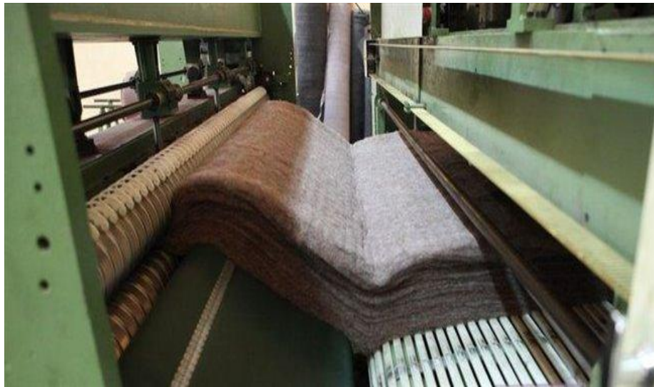
Рис. 4. Голкопробивний метод промислового виготовлення повсті. Джерело: [6]
