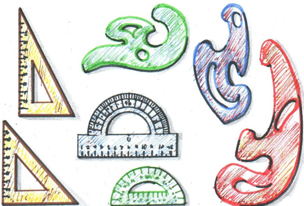
Рис. 2. Інструменти: а – косинці; б – транспортир; в – лекала
